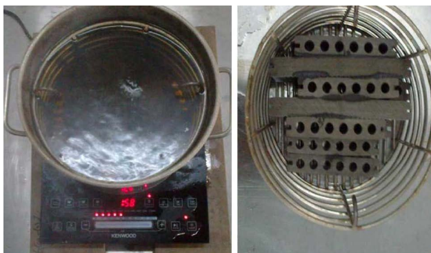
Supradeck. Después de 60 h de ebullición
