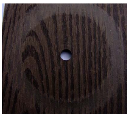
Convencional. Peso del polvo generado: 81 mg
