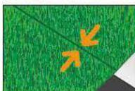
Placer les 2 lés de gazon synthétique sur le joint et appliquer les 2 bords de façon à ce qu'ils se joignent parfaitement. Si besoin, reprendre au cutter le bord du lé entre 2 coutures afin de conserver un espacement régulier. Veiller à ce que les fibres soient toujours inclinées dans le même sens.
